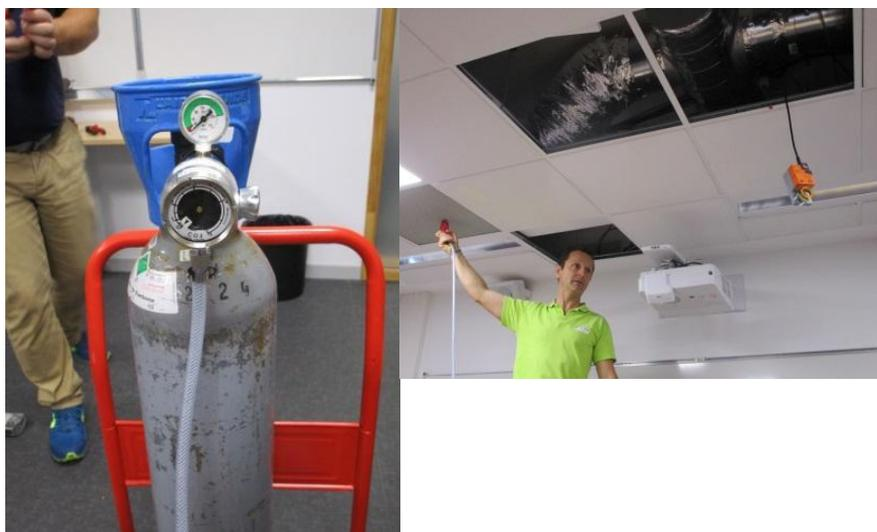
Injection de CO2 – déclenchement modulation
