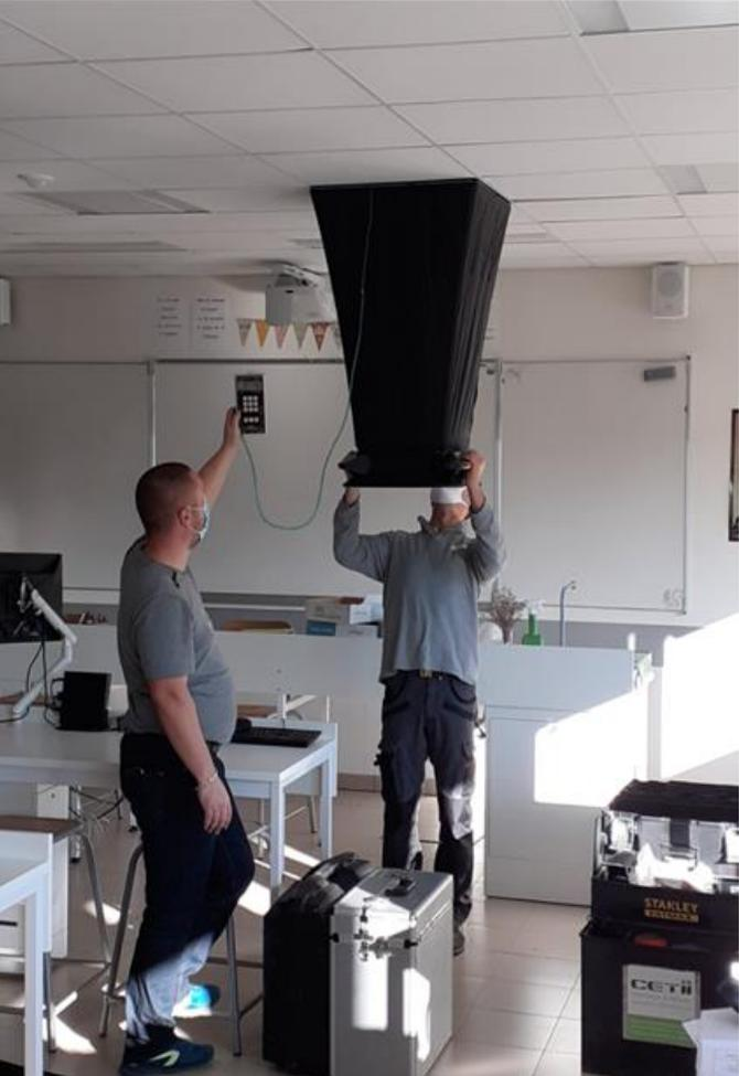
Mesure de débit au balomètre avec relevé de la perte de charge de l'équipement
