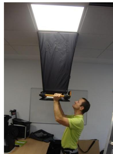
Mesure au balomètre
