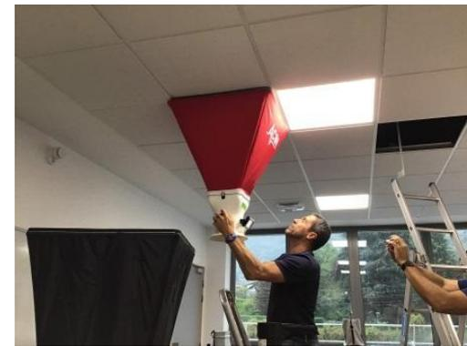
Mesure avec cône à compensation
